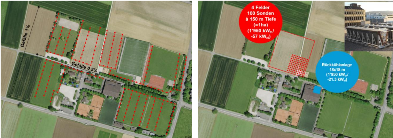
Abbildung 19 Geothermiepoteziale mittels Erdsonden in Aesch. Beispiel im Gebiet Löhrenacker mit Anordnung ohne Regeneration in Sondenreihen (links) mit 259 Sonden à 150m, sowie mit Regeneration als Sondenfeld mit Rückkühler pro Hektar (rechts).
