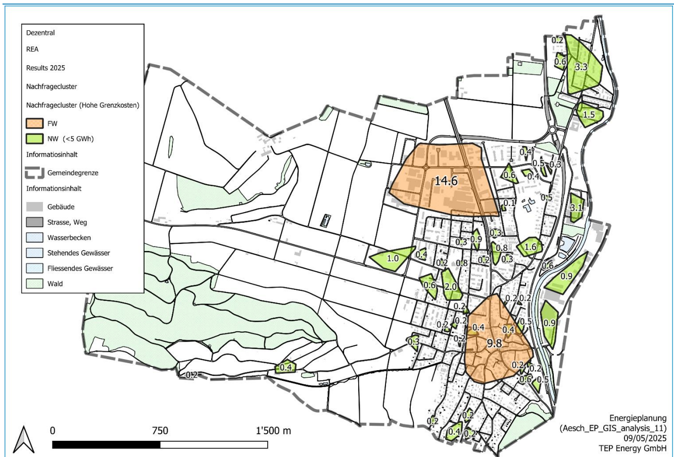
Abbildung 15 Nachfrageseitige Potenziale für thermische Netze im Jahr 2035 bei hohen Grenzkosten der Verteilung. Flächen zeigen die Hüllkurven der Cluster, Werte sind in GWh Endenergie.
